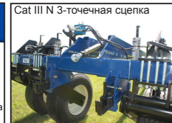
Cat III N передняя сцепка с 3-точечным подвесом
